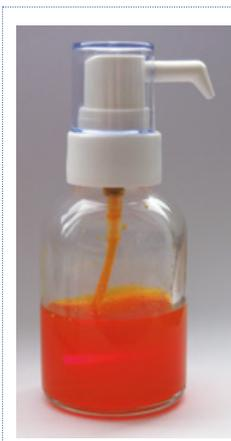
Abb. 2: Die Abbildung zeigt eine Coenzym Q10-Emulsion (ca. 5% Q10) mit Phospholipiden, mit einem Tröpfchendurchmesser im Bereich von 60 nm. Durch die unterschiedliche Lichtbrechung Wasser/Öl wird das Licht eines seitlich von links einfallenden Laserstrahls gestreut, sodass der Strahl sichtbar wird (sog. Tyndall-Effekt).
